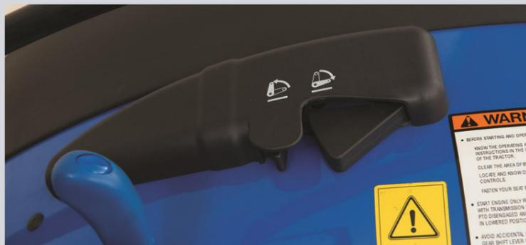
*Lift-O-Matic™*: melhor controle e uniformidade durante as operações, chegando a uma capacidade máxima de 2.600 kgf do levante hidráulico.
