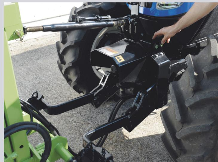
Capacidade de levante frontal de 1.275 kg e TDF de 1.000 rpm.
