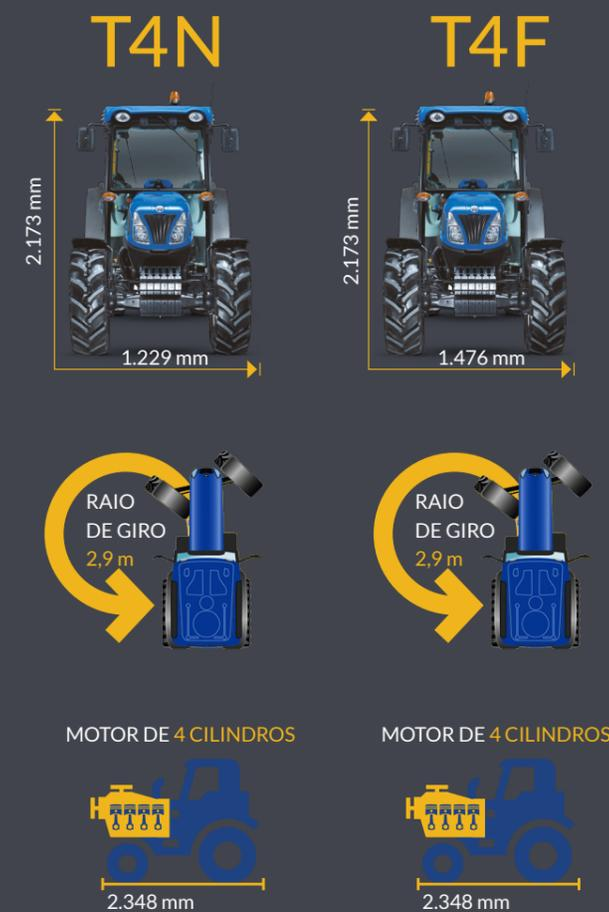
A mesma versatilidade pode também ser vista na altura máxima. No trator cabinado de 88 cv, por exemplo, ela chega a 2,17 m. Enquanto isso, na versão plataforma, com o ROPS (arco de proteção) rebatido na posição horizontal, à altura
