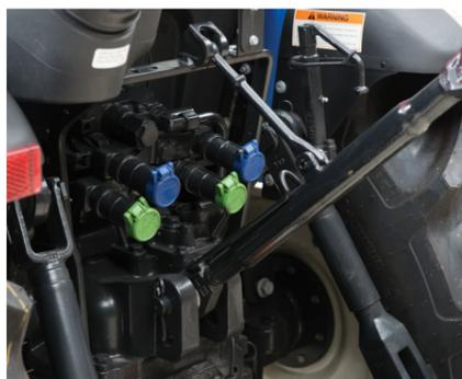
Em se tratando de capacidade de trabalho com implementos, é importante também serem destacadas as elevadas vazões hidráulicas – de 48 e de 64 litros por minuto – e o número de válvulas remotas – até 3 –, fundamentais ao acionamento de implementos de colheita e a todos aqueles que requeiram elevadas vazões hidráulicas.
