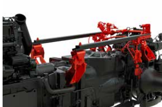
Den semi-aktive hydrauliske kabineaffjedring absorberer effektivt rystelser og vibrationer.
