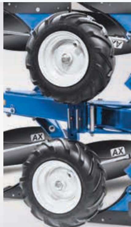
Podwójne koło ogumione montowane w obrębie ramy 23x8,50-12
