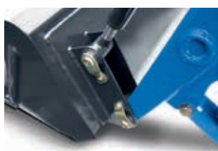
Verrouillage d'outil par broche sur 300TL
