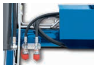
Raccord pour 3 ème fonction hydraulique sur 500TL
