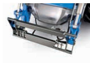
Verrouillage hydraulique de l'outil sur 600LA et 700LA
