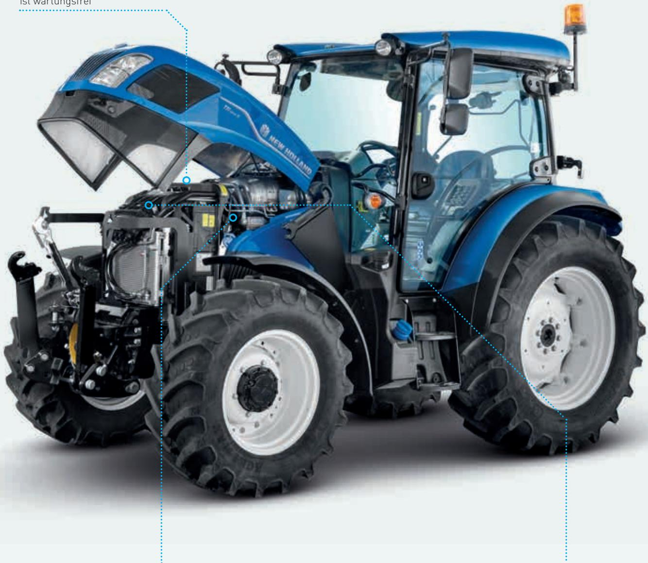
Alle Wartungsarbeiten können von einer Traktorseite aus ausgeführt werden. Die Wartungspunkte sind zugangsfreundlich auf der linken Seite angeordnet
