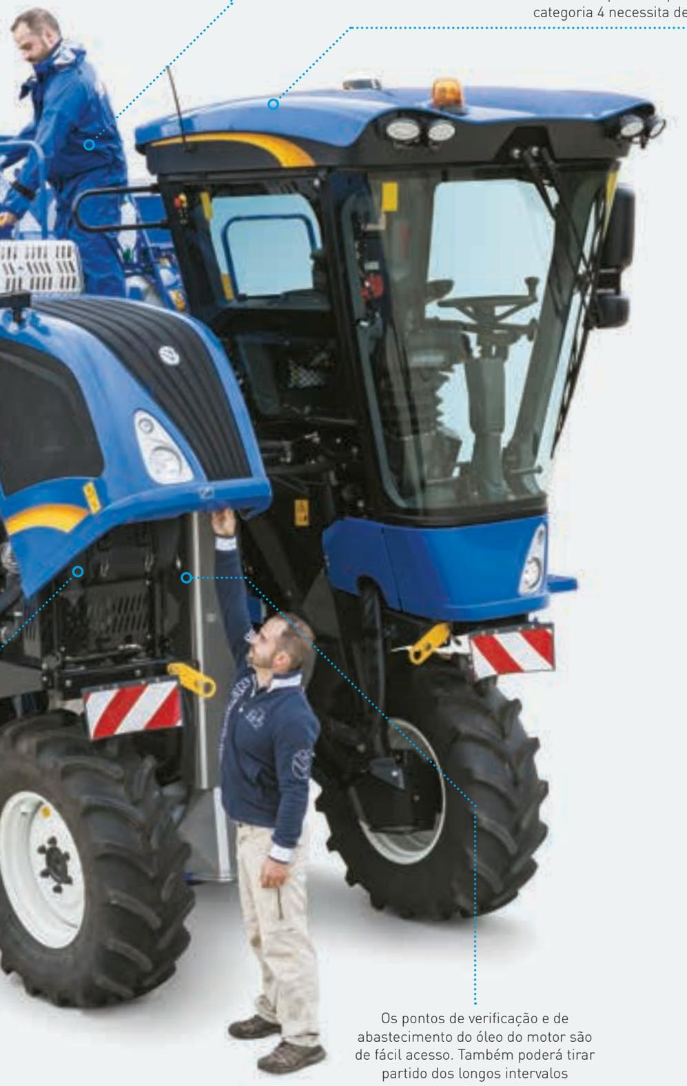
Os pontos de verificação e de abastecimento do óleo do motor são de fácil acesso. Também poderá tirar partido dos longos intervalos de manutenção de 600 horas, típicos da New Holland.
