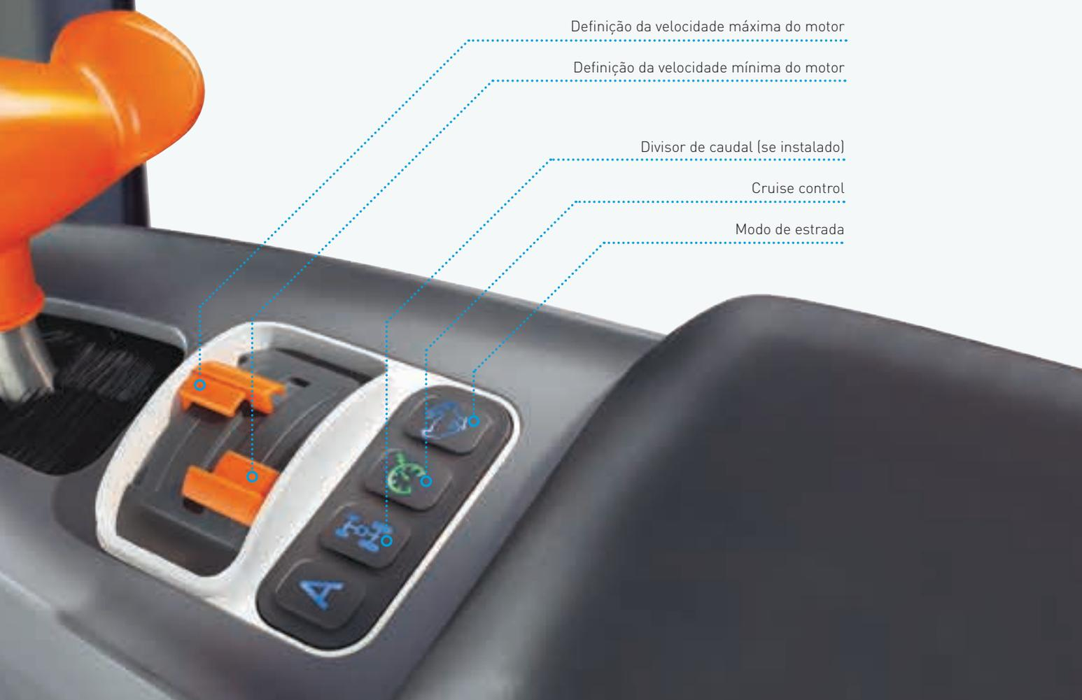
Definição da velocidade máxima do motor
