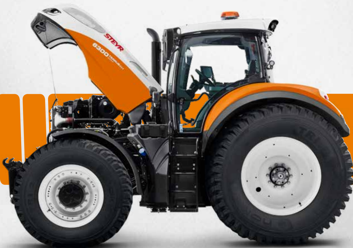
Ciągłe czyszczenie za pomocą filtra Piclon dba o to, aby filtr musiał być konserwowany tylko wtedy, gdy zaświeci odpowiednia lampka ostrzegawcza.
