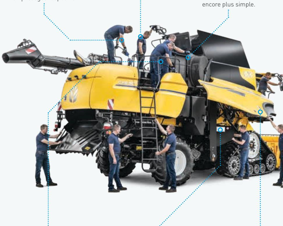
Le filtre à air du moteur est accessible depuis la plate-forme du compartiment moteur.
