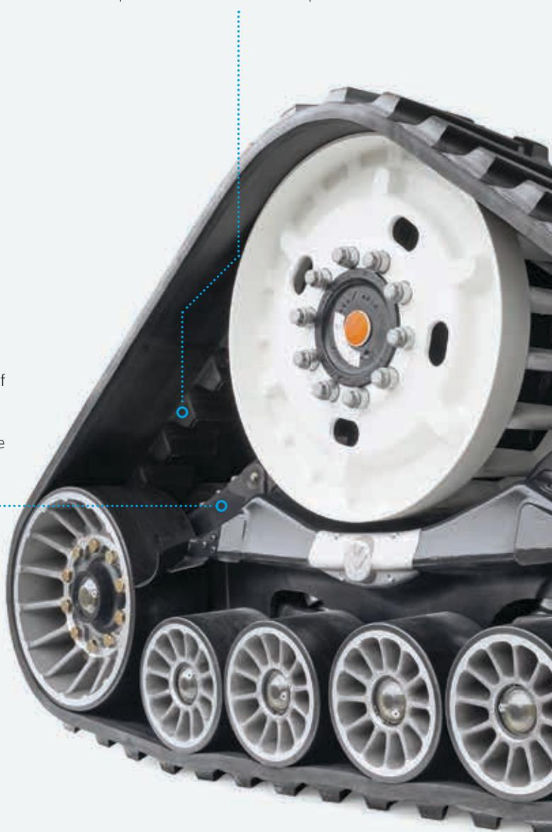
Les chenilles SmartTrax™ possèdent un dispositif automatique de tendeur haute performance qui garantit une tension parfaite pour obtenir un fonctionnement idéal. De plus, pour davantage de simplicité et de fiabilité, le dispositif de tendeur est totalement indépendant du barbotin.
