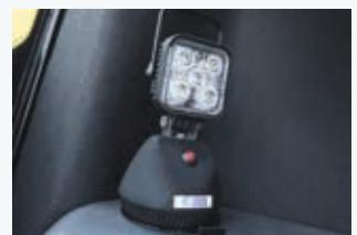
Un système d'éclairage portable à LED permet de bénéficier d'une visibilité à 360° pendant les interventions d'entretien.
