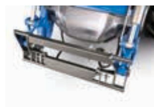
600LA e 700LA, bloqueio do equipamento hidráulico
