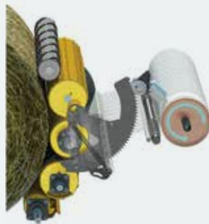
**2** Le filet est appliqué sur la balle lorsque le bec de canard pivote dans la chambre.
