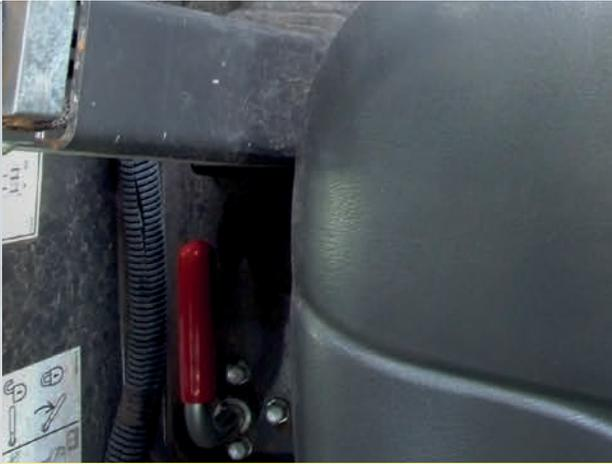
El operador podrá acoplar y desacoplar el bloqueo del brazo desde adentro de la cabina para dar más seguridad al arrancar la máquina con el brazo elevado.
