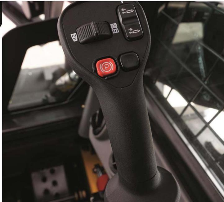
Los interruptores están posicionados en las palancas de control permitiendo la operación fácil de recursos como bocina, flujo proporcional, luces de dirección, dos velocidades, fluctuación de la cuchara, controles múltiples funcionales de los accesorios y el LTS (Load Travel Stabilizer).
