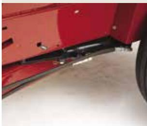
El giro hidráulico de la lengüeta utiliza un músculo hidráulico para girar la empacadora a la posición de transporte o de trabajo de forma rápida y sencilla.
