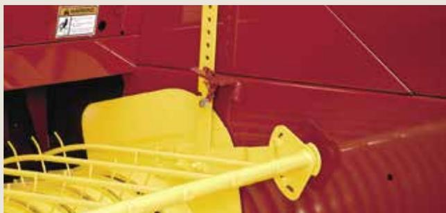
Los recolectores se levantan manualmente y bloquean en la posición de transporte. El elevador hidráulico del recolector simplifica la subida y bajada de la camioneta. Es estándar en el Hayliner BC5070, pero opcional en otros modelos.
