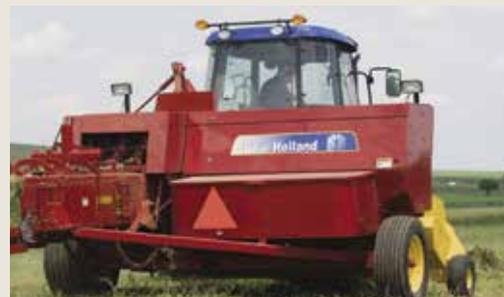
Las luces de carretera brindan visibilidad al remolcar y las señales de giro para mayor seguridad. Faros de trabajo. Las luces halógenas brillantes proporcionan mayor iluminación para empacar de noche.
