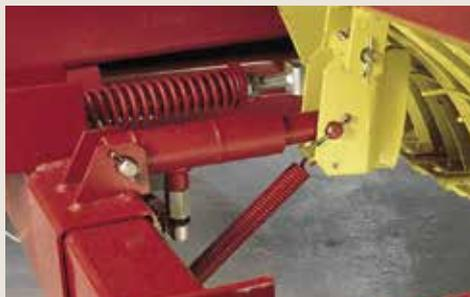
Elevador hidráulico de recogida. (Se muestra desde la parte trasera de la empacadora). Al empacar, suba o baje su colector según necesario para adaptarse a diferentes terrenos sin levantarse del asiento del tractor.
