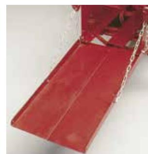
La rampa de tres usos soporta las pacas cuando salen de la cámara; se puede configurar para enrollar las pacas hacia la izquierda, lejos de la siguiente hilera. (También se convierte en la base del conducto de carga de pacas).
