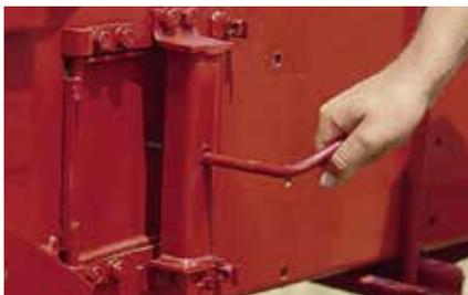
Las puertas de tensión de pacas ajustables en los modelos BC5060 y BC5070 facilitan el cambio de densidad de pacas en la caja de pacas
