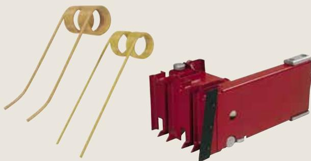
Compare el diente de recogida SuperSweep de la izquierda con el diente recto que se utiliza en los recolectores normales. Esa curva adicional marca la diferencia en la recolección de más cultivos. El émbolo funciona sobre rodillos con cojinetes de bolas sellados y guías de hierro blanco resistentes al desgaste para menos mantenimiento y ajustes.
