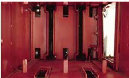
La cámara de pacas resistente está diseñada para una mejor formación de las pacas. Seis caballetes para heno mantienen las cargas en posición para obtener pacas firmes y de calidad.
