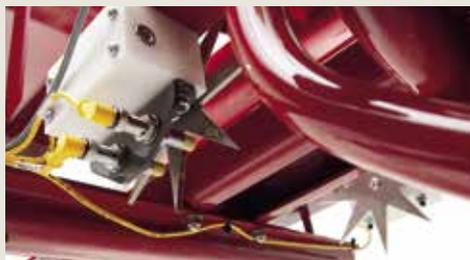
Los aplicadores automáticos CropSaver cuentan con ruedas de estrella gemelas montadas en la parte inferior del conducto de pacas que miden la humedad en cada paca y adaptan continuamente la tasa de aplicación cada tres segundos para responder a los cambios de humedad.
