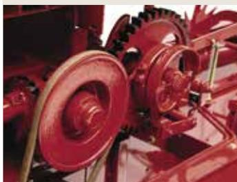
La transmisión por engranajes del anudador rediseñada facilita el mantenimiento o el reemplazo de la correa de recogida.
