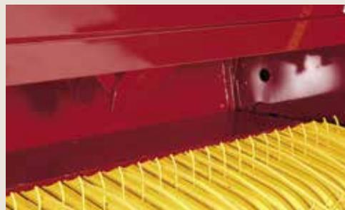
El piso de alimentación reemplazable en todos los modelos brinda resistencia al desgaste, facilidad de servicio y mayor vida útil de la empacadora
