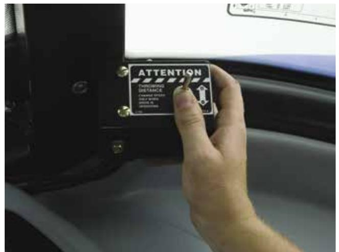
El controlador de distancia y dirección se conecta al tractor. El interruptor de palanca controla la velocidad de los cinturones de lanzamiento para la distancia.
