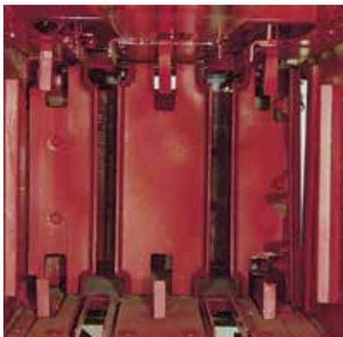
Una caja grande de ocho bolas en el Hayliner BC5070 le permite empacar por más tiempo sin volver a enhebrar. Convenientemente ubicada en la parte trasera de la empacadora, la caja tiene una tapa con bisagras para mantener el hilo limpio y seco.
