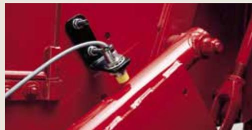
El aplicador automático CropSaver con contador de golpes utiliza sensores de posición para detectar cuándo se ata cada paca, el número de golpes por paca y determina las toneladas por hora recolectadas. Esta información, que se muestra en el monitor, permite al operador ajustar la velocidad de empacado para maximizar la productividad y mantener una longitud de paca precisa.
