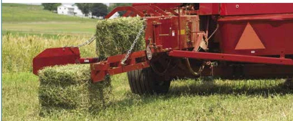
La rampa de pacas de un cuarto de vuelta deja caer las pacas de costado, por lo que el hilo se mantiene alejado del suelo para evitar que se pudra. Coloca la paca en la posición adecuada para que la recupere mediante un carro de pacas automático. También se recomienda la extensión de la caja de pacas cuando se utiliza la rampa de pacas de un cuarto de vuelta.
