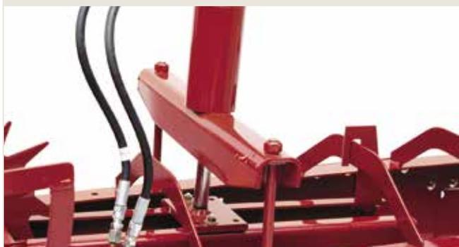
También puede equipar su empacadora con control de tensión de pacas hidraformáticas. Esta característica ayuda a mantener una densidad uniforme de la paca en diferentes condiciones de cultivo.
