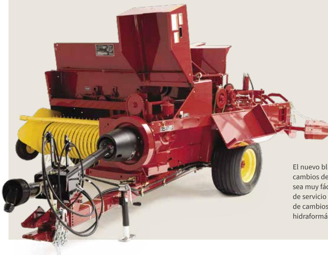
El nuevo blindaje de la caja de cambios delantera abatible hace que sea muy fácil acceder a los puntos de servicio clave, como la caja de cambios principal y el sistema hidraformático.
