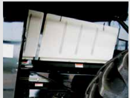
Hervorragender Wartungszugang durch Abnehmen der weißen Kunststoffverkleidungen.
