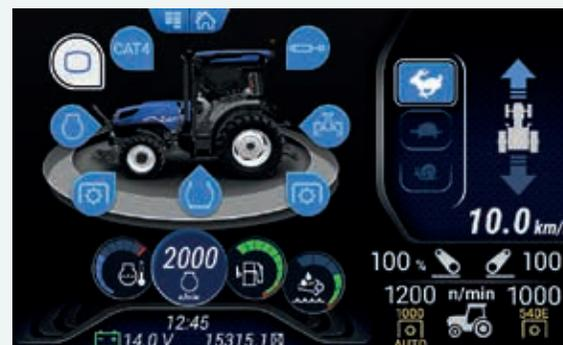
Dalla schermata principale si accede facilmente a 8 sottomenu per regolare funzionalità come portata dell'olio idraulico, automatismi della presa di potenza, dimensioni dell'attrezzo, gestione del sistema Blue Cab™ 4... Grazie al suo design ed ergonomia, questo schermo mantiene inalterata la perfetta visibilità verso l'esterno della cabina.
