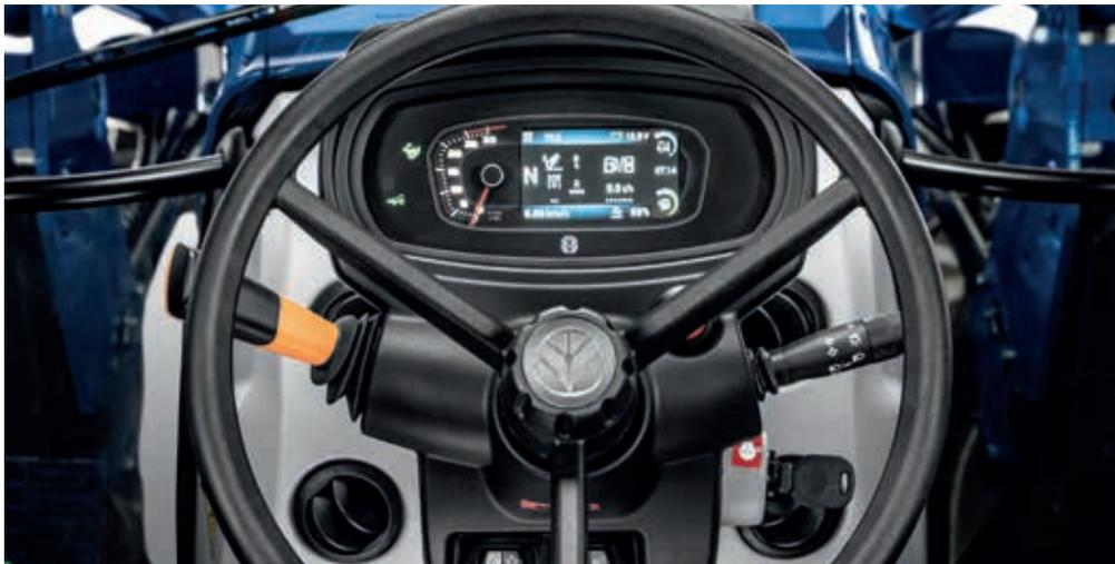
El diseño y ergonomía de los nuevos interruptores proporcionan un manejo positivo y preciso de las funciones clave, mientras que un nuevo tablero de instrumentos con pantalla de información digital ofrece datos claros y precisos sobre todas las funciones importantes, manteniéndole bien informado sobre el rendimiento del tractor y el estado de aspectos clave como el nivel de combustible y el régimen del motor. El resultado: Obtendrá más de su tractor.
