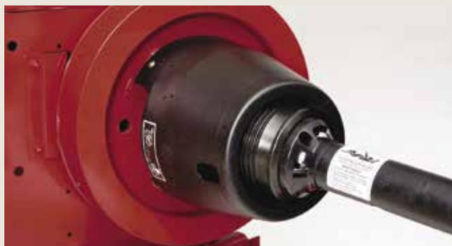
Uma tomada de força reforçada é equipamento de série nos Modelos BC5060 e BC5070.
