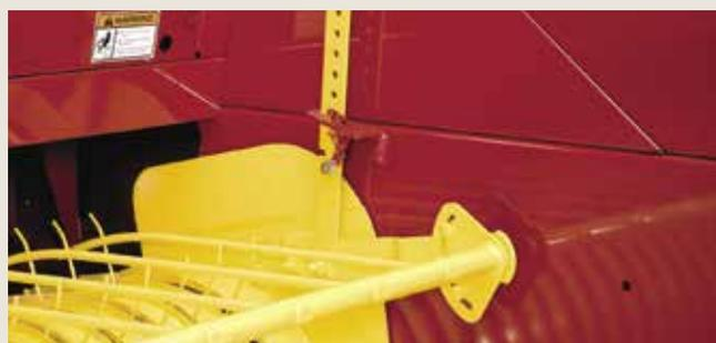
Os coletores são levantados manualmente e travados na posição de transporte. O elevador hidráulico do coletor simplifica a elevação e o abaixamento do coletor. É equipamento de série na BC5070 Hayliner e opcional nos outros modelos.
