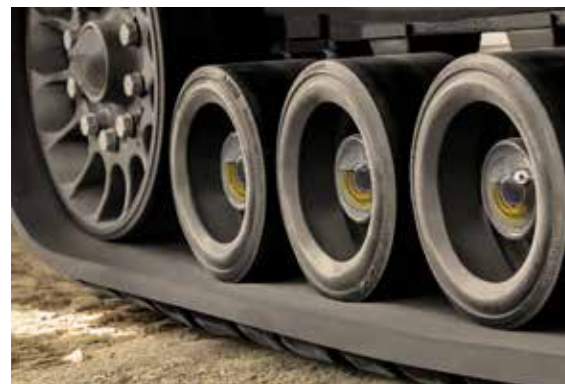
Öl-Schaugläser in den Radnaben verkürzen den täglichen Inspektionsaufwand.
