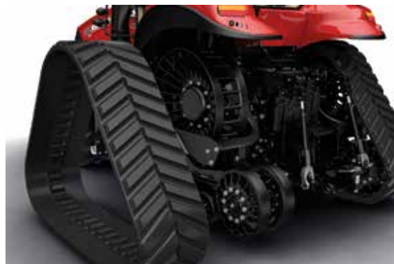
Der kraftschlüssige Antrieb verhindert Schlupf zwischen dem Antriebsrad und dem Gummilaufwerk, egal bei welchen Verhältnissen.
