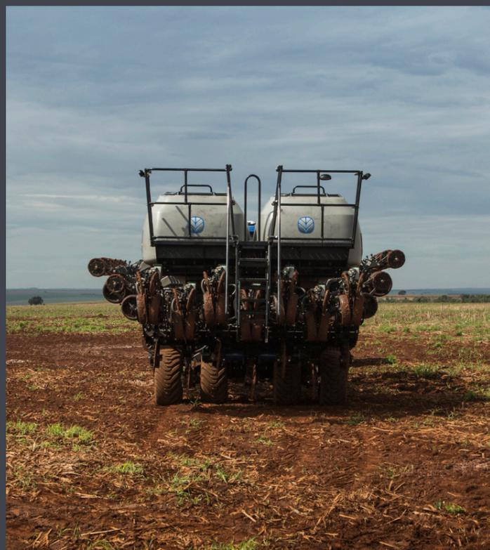
As PL7000 3s em modo de transporte ficam com largura de 3,2 m a 3,6 m, facilitando a movimentação nos carregadores da fazenda, de forma prática para transporte embarcado.
