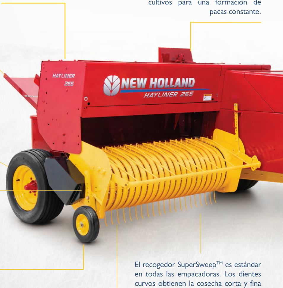
El recogedor SuperSweep™ es estándar en todas las empacadoras. Los dientes curvos obtienen la cosecha corta y fina otros colectores fallan mientras que la visibilidad del colector asegura una alimentación sin tapones.
