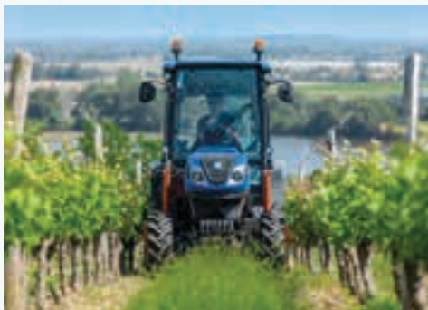
Zwischen den Reihen zu Hause Außenbreite von 1,06 m - 2,02 m
