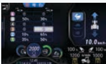
Einstellung der elektr. Steuergeräte.
