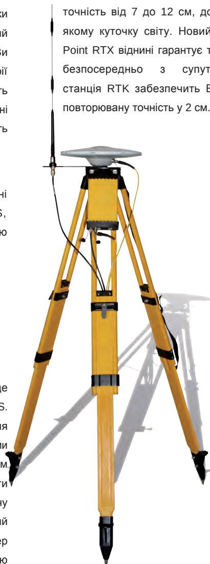
Базова станція RTK
