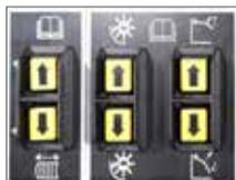
Facile regolazione della velocità di trinciatura o passaggio dallo spargimento all'andatura tramite un pulsante esterno sul fianco della mietitrebbia
