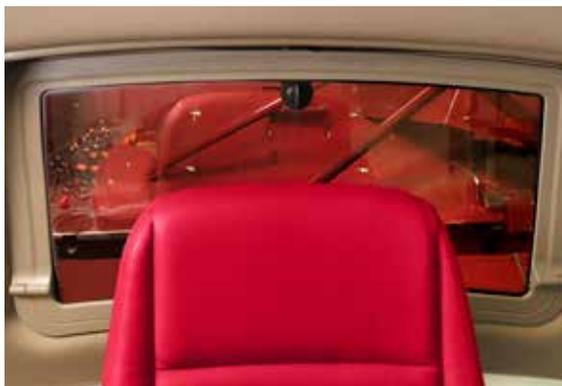
Ampia finestrella di ispezione dietro il sedile dell'operatore
