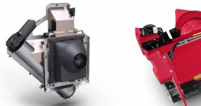
Telecamere di controllo della granella per determinare la presenza di chicchi danneggiati e di impurità nel campione prodotto
