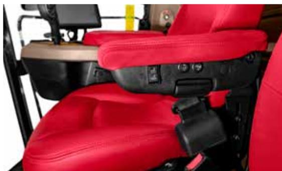
Sedile a sospensione pneumatica oppure sedile in pelle semiattivo ventilato e riscaldato con comandi per un comfort da automobile di lusso
