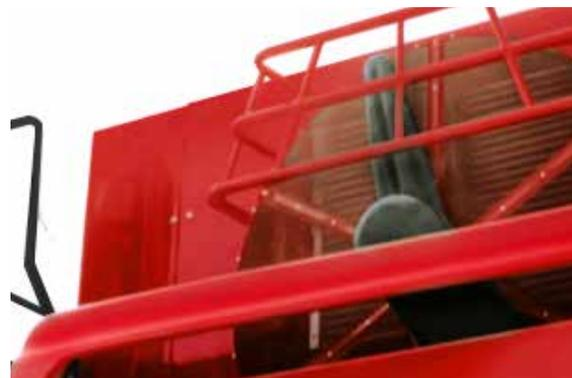
Griglia del radiatore fissa per una rimozione ottimale della polvere
