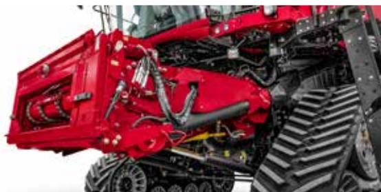
Inclinazione longitudinale (avanti/indietro) per impostare l'angolo della testata - in questo modo è possibile prelevare, senza perdite di prodotto, tutti i raccolti allettati
