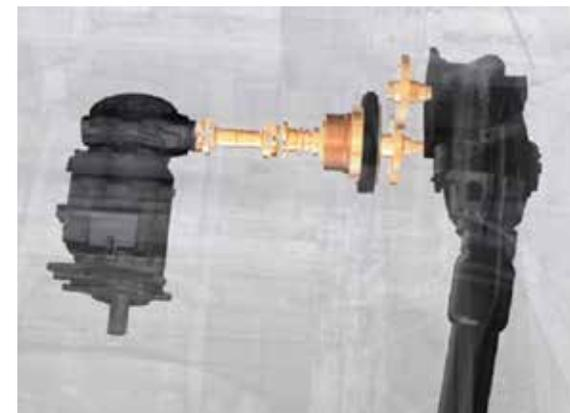
Trasmissione del rotore: compatta senza cinghia con riduttore a tre velocità per velocità basse nelle colture delicate
