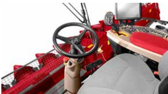
Piantone dello sterzo pieghevole con nuovo interruttore di emergenza e volante regolabile in profondità - nessun intralcio alla visuale
