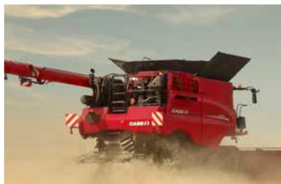
L'organo di taglio del sistema Xtra-Chop è montato sul retro della mietitrebbia per la trinciatura fine in condizioni difficili o per operazioni di andatura. Novantasei coltelli e 12 pale del ventilatore provvedono rispettivamente a trinciare e a inviare il residuo in una corrente d'aria su tutta la larghezza di lavoro
