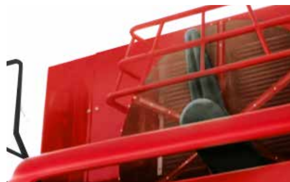
Brosse rotative pour dépoussiérage optimal.
