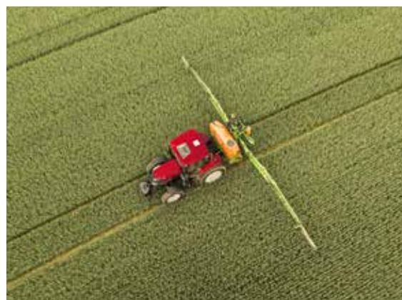
AFS AccuGuide: GPS- og Glonass-baseret sporstyring
