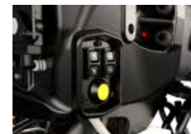
De udvendige betjeningselementer til den hydrauliske lift og til PTO sidder foran og bag på traktoren, og der findes endvidere en ekstra styreenhed.
