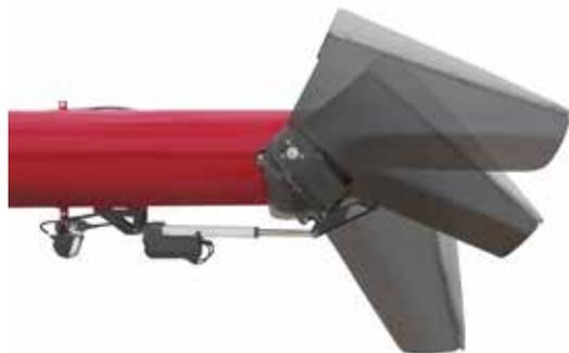
Der auf Wunsch schwenkbare Auswurftrichter wird mit dem Multifunktionshebel bedient und richtet den Körnerstrom direkt auf den Zielbereich im Überladewagen, so dass dieser ohne Rieselerluste vollständig gefüllt werden kann.
