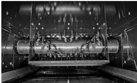
Durch Feststellen der Gegenmesser in den Rastpositionen des Strohkanals lässt sich die Häckselaggressivität an die Bedingungen anpassen. Bei der Schwadablage wird das Gegenmesser eingezogen, und der Häcksler läuft mit reduzierter Drehzahl, damit das Stroh sauber abgelegt wird und sich gut verpressen lässt.
