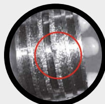
USZKODZENIE TŁOKA POMPY
