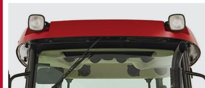
Até quatro faróis de serviço ajustáveis podem ser instalados na cabine para melhorar a visibilidade noturna.
