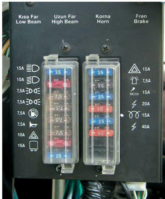
Todos os fusíveis são do tipo automotivo e facilmente identificáveis para tornar mais fácil a detecção de defeitos e a sua substituição.
