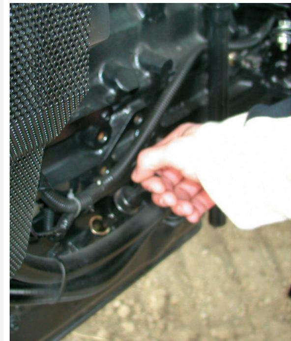
Verificação do óleo do motor sem levantar o capô.
