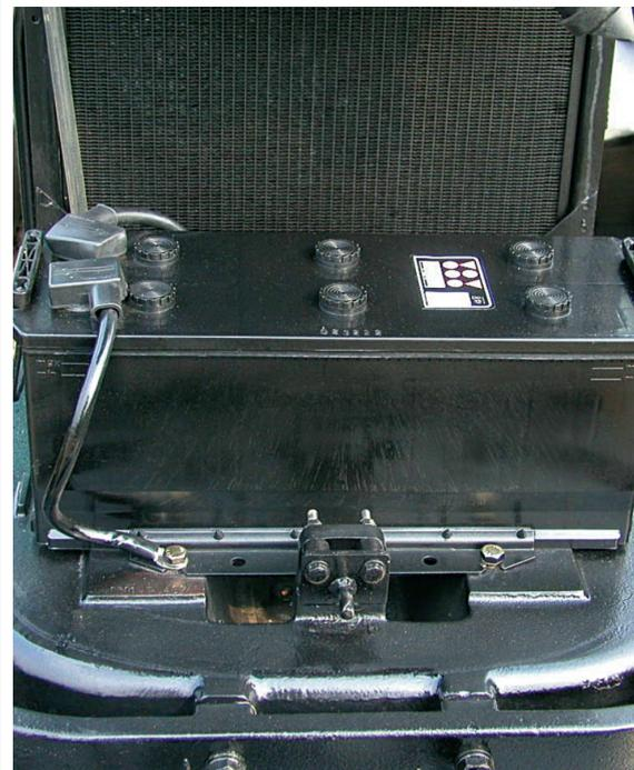
A bateria é montada debaixo do capô do motor, na parte dianteira do trator.
