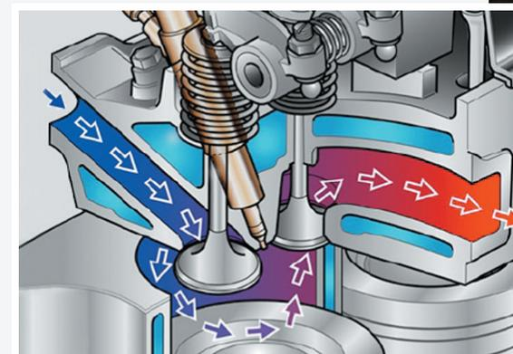
O projeto do cabeçote do cilindro "CrossFlow" permite a redução do consumo de combustível. Todos os modelos são turboalimentados com intercooler.
