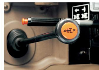
Nas transmissões 12x12 e 20x12, as mudanças de marcha são realizadas sem esforço por meio do “Shuttle Command”, instalado no lado esquerdo do operador.
