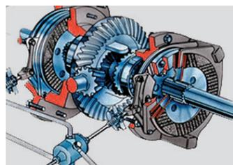
Todos os tratores Farmall são equipados com freios a disco banhados a óleo e acionados mecanicamente.
