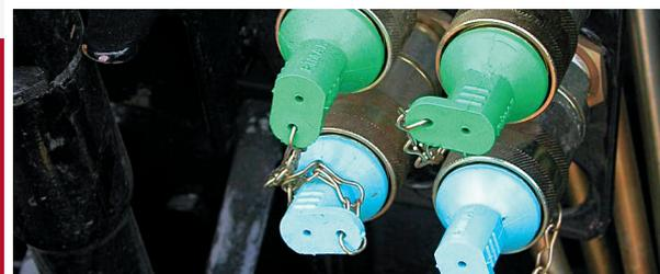
O sistema auxiliar de válvula remota oferece duas válvulas traseiras.
