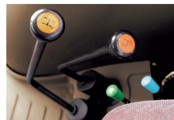
Todas as transmissões dispõem de alavancas de comando posicionadas ergonomicamente.
