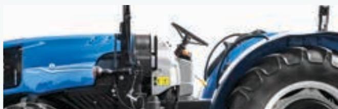
ROPS en posición central con amortiguador de gas especializado para huertos
