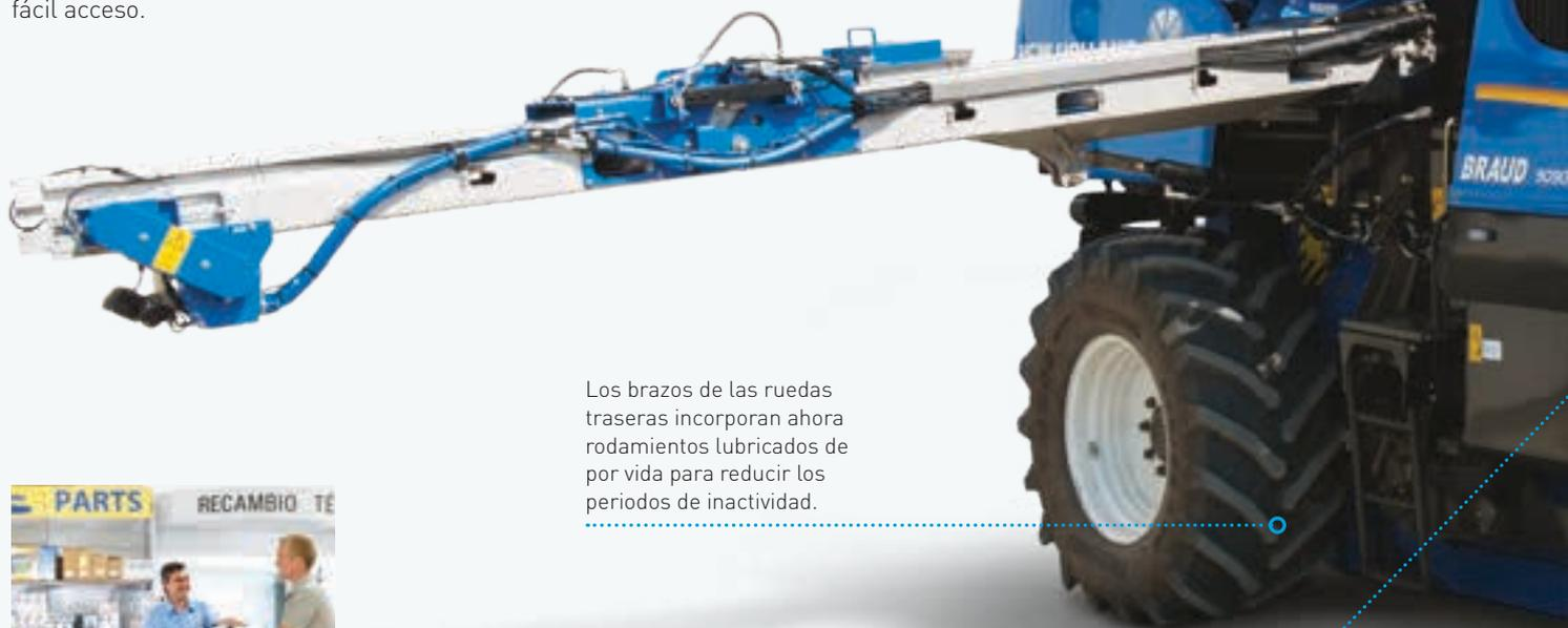
Los brazos de las ruedas traseras incorporan ahora rodamientos lubricados de por vida para reducir los periodos de inactividad.
