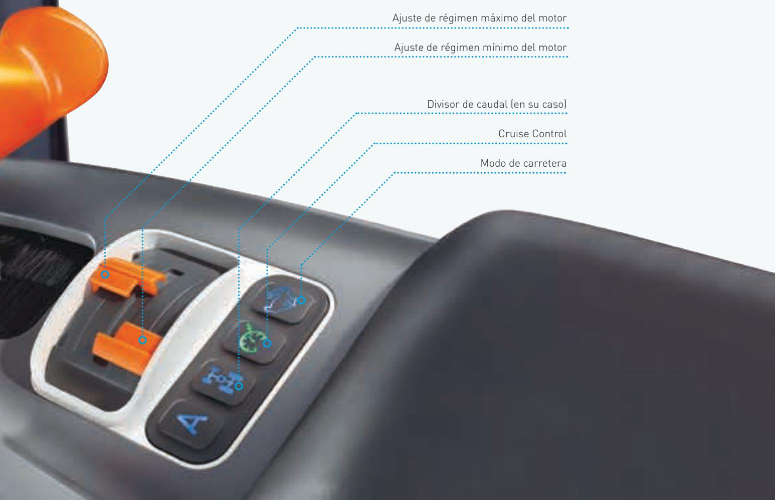
Ajuste de régimen máximo del motor
