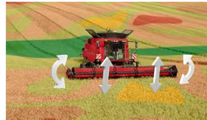
La tecnologia Case IH Terrain Tracker permette di mantenere l'esatta altezza di taglio su tutti i terreni, anche quelli più irregolari.
