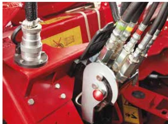
La testata può essere montata in pochi minuti grazie all'unico comando di sblocco che collega tutte le linee idrauliche
