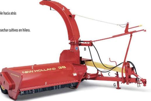
La Crop-Chopper® puede3 ser usada con cualquier tractor equipado con barra de tiro estándar, TDF estándar de 540 rpm. Se recomineda un tractor con potencia entre 45 a 65 hp para mejor desempeño.
