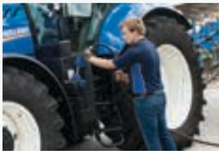
Spezieller Einfüllstutzen des AdBlue-Tanks, so dass ein versehentliches Einfüllen von Kraftstoff ausgeschlossen ist. Der AdBlue-Tank muss nur bei jeder zweiten Füllung des Kraftstofftanks befüllt werden.
