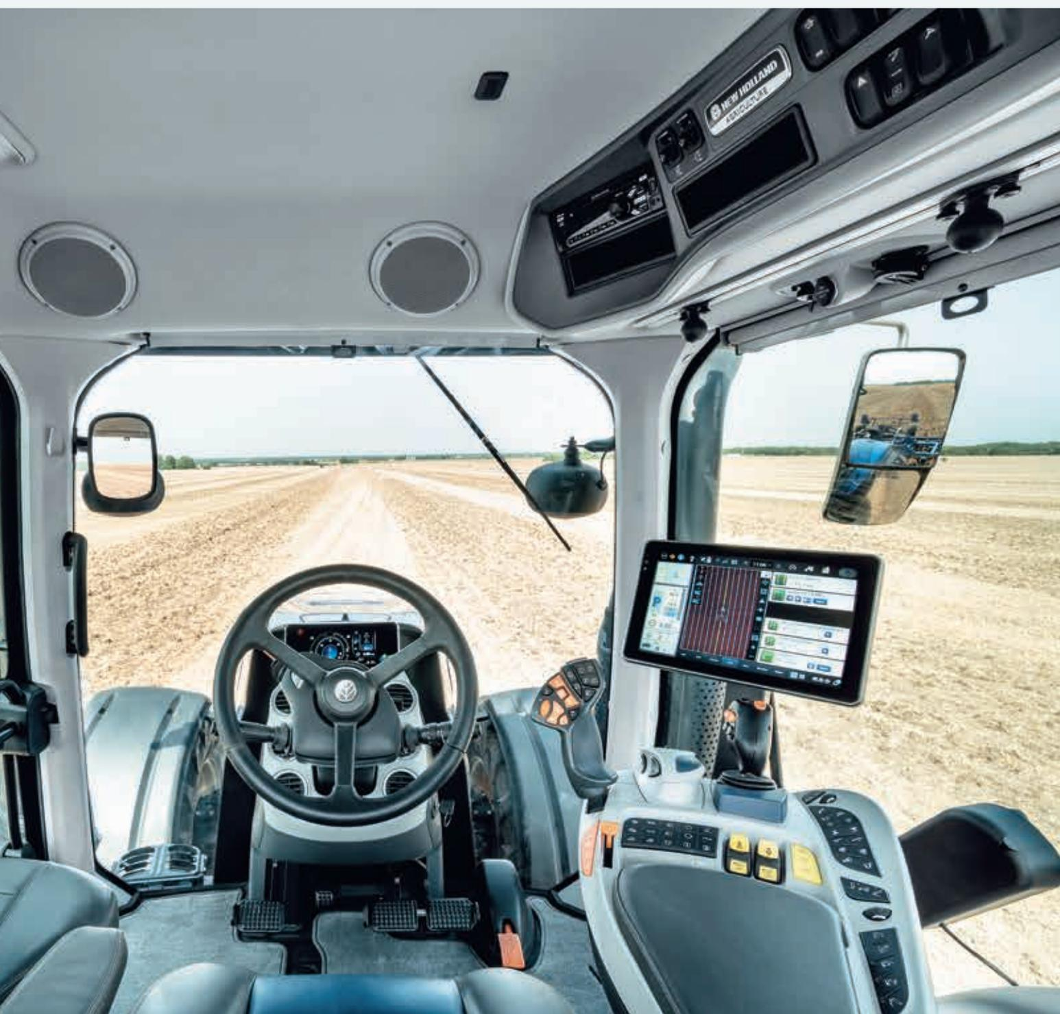
Grâce au pare-brise en verre feuilleté, aux joints de fenêtre et de porte en caoutchouc plus épais, au tapis de sol plus moelleux et à une meilleure isolation sous le plancher de la cabine, la nouvelle cabine T8 Genesis™ est plus silencieuse que jamais.
