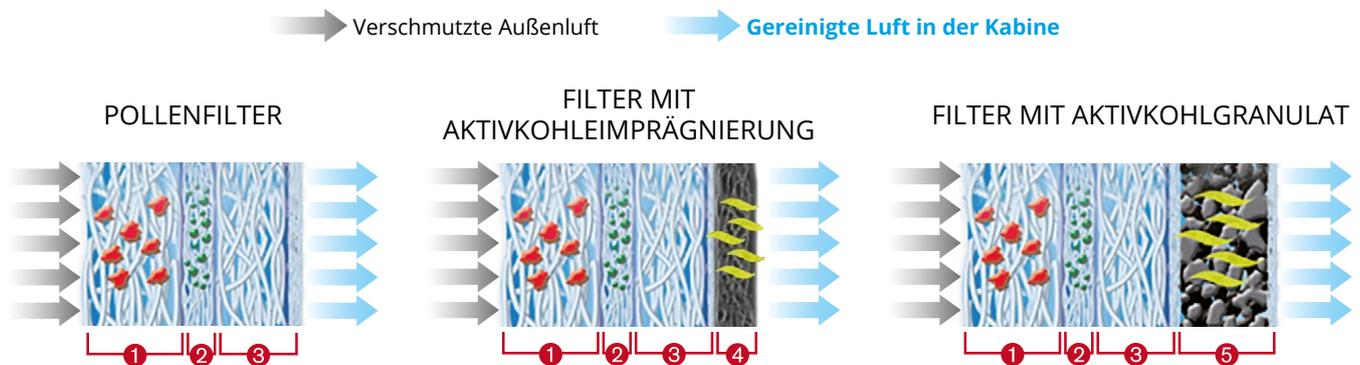
1 Vorfilter: filtert die größten Partikel (insbesondere die Schmutzpartikel).
