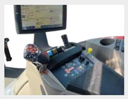
PUMA MULTICONTROLLER MODELS WITH POWERDRIVE TRANSMISSION
