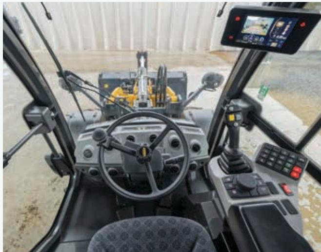
El nuevo diseño de la cabina para W100D ofrece una visión casi sin obstáculos de 360° gracias a su posición de conducción elevada y a la amplia superficie acristalada entre cuatro pilares estrechos. Las puertas de cristal de amplia apertura garantizan un fácil acceso al interior luminoso y espacioso, con bajos niveles de ruido de 71 dBA.
