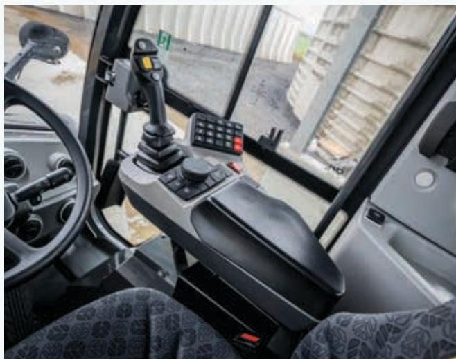
Los controles están agrupados estratégicamente al alcance de la mano del joystick multifunción, integrado en el reposabrazos derecho. El reposabrazos se monta en el asiento del conductor con suspensión neumática, moviéndose sin problemas con usted en terrenos irregulares para ofrecer la máxima comodidad.
