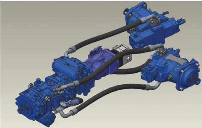
El sistema de transmisión hidrostática asegura siempre el suministro de energía adecuada al par requerido para el trabajo, evitando deslizamientos. El tractor puede realizar fácilmente curvas con tracción en ambas las orugas o incluso realizar giros alrededor de su eje central, sin salir del lugar (contrarrotación). Al tener menos componentes que una solución estándar, el mantenimiento es más rápido, sencillo y menos costoso.
