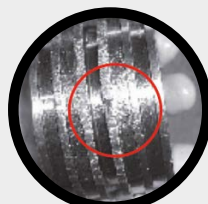
ENDOMMAGEMENT DU PISTON DE LA POMPE
