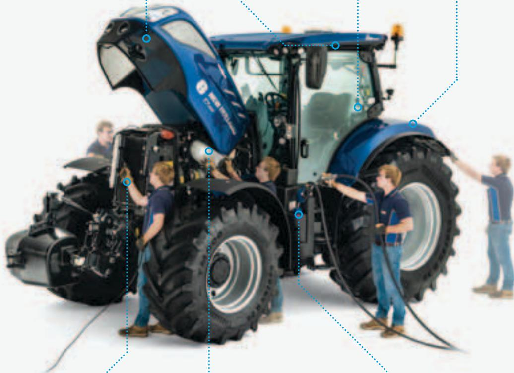
O sistema de refrigeração abre-se para permitir uma limpeza rápida e fácil.
