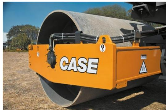
В состав системы привода вальца входит дополнительный высокомоментный гидромотор, установленный на раме переднего вальца. Он обеспечивает превосходную способность машины преодолевать уклоны (36 % в непрерывном режиме и 40 % в прерывистом), а также гарантирует оптимальное тяговое усилие.
