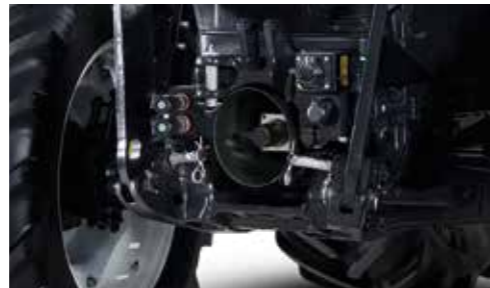
Nouvelle prise de force avant avec embrayage humide
