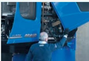
O capô do motor de dois blocos abre-se na totalidade para permitir um acesso total: o capô dianteiro gira totalmente para permitir o acesso para procedimentos de manutenção, a porta lateral gira sobre uma mola acionada por gás para limpeza e manutenção dos componentes hidráulicos e arrefecedores.
