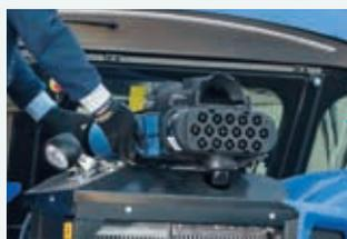
O filtro de ar do motor é fácil de verificar, limpar ou substituir, sem ser necessário utilizar ferramentas, sendo acessível a partir do solo.
