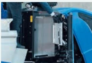
O sistema de refrigeração abre-se para permitir uma limpeza rápida e fácil.
