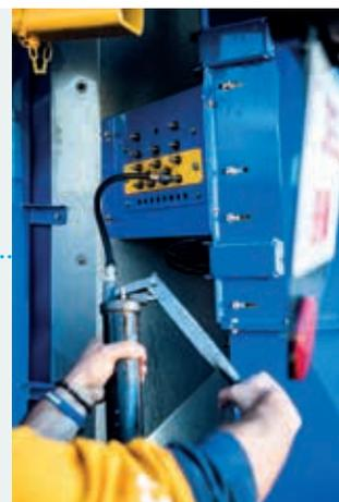
Para facilitar e reduzir a manutenção, todos os pontos de lubrificação da cabeça de colheita estão agrupados e têm acesso fácil a partir do nível do solo.
