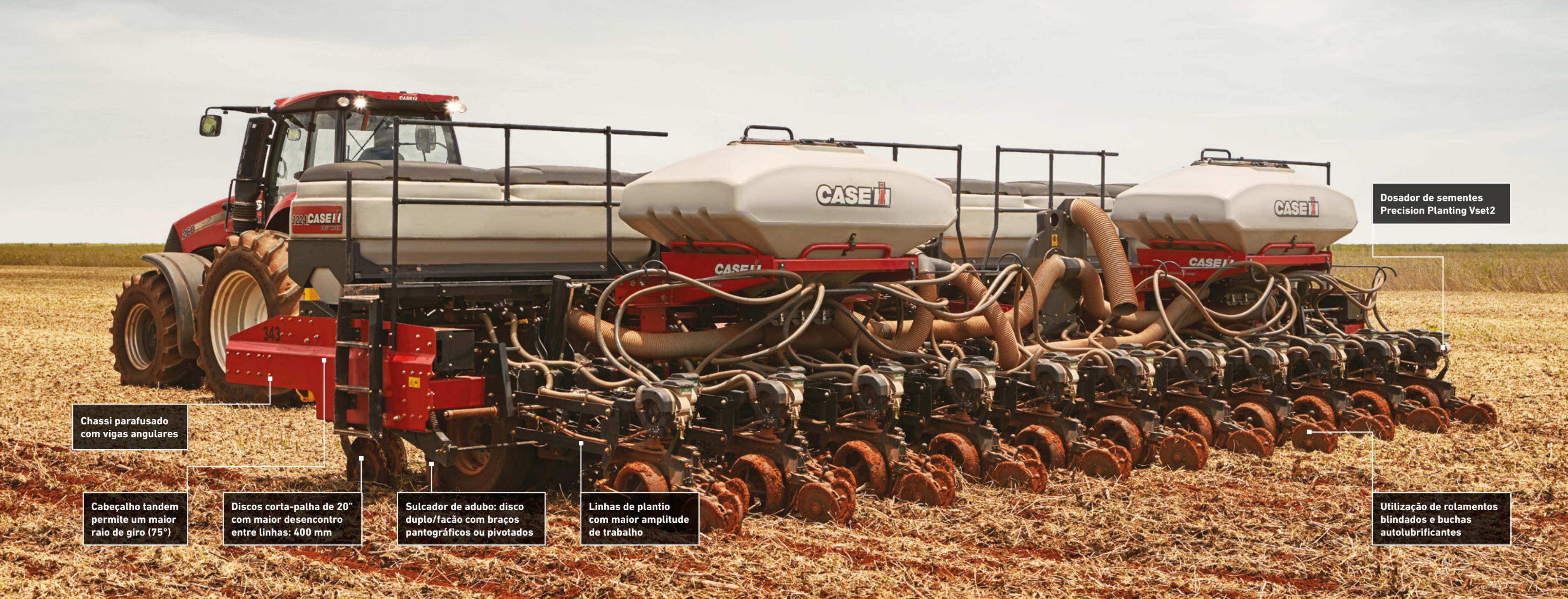
Chassi parafusado com vigas angulares
