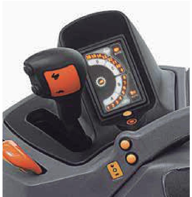
**Transmisión ElectroShift™ 16x16 con powershuttle.**
