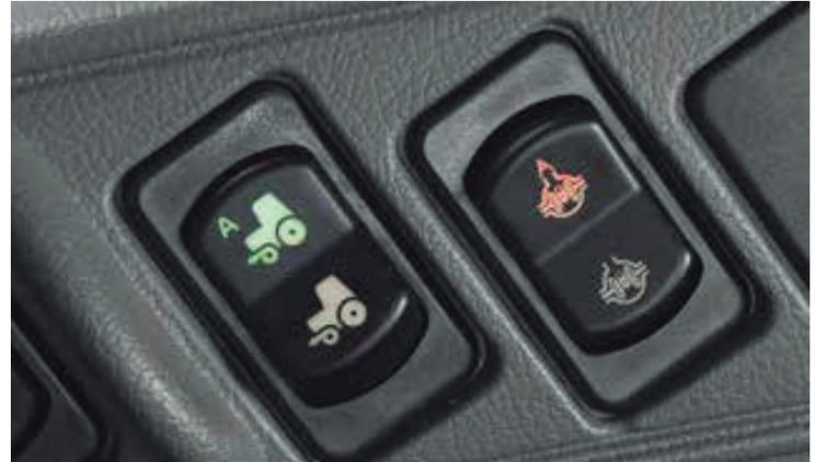
**El sistema Terralock™ controla automáticamente el FWD y el bloqueo del diferencial para brindarle la máxima tracción y control.**
