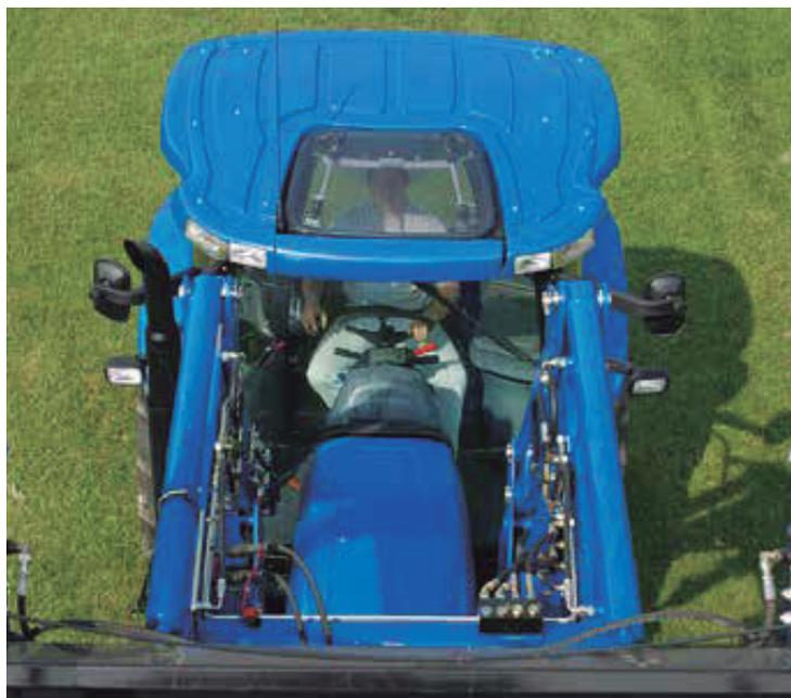
**La cabina Horizon™ cuenta con una ventana de alta visibilidad en el techo (opcional) para facilitar la vista en caso de instalar un cargador frontal.**
