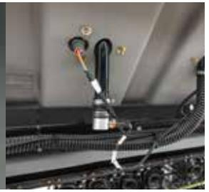
Sensores de presión en tanque
