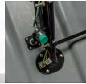
Sensor de bajo nivel en tanque
