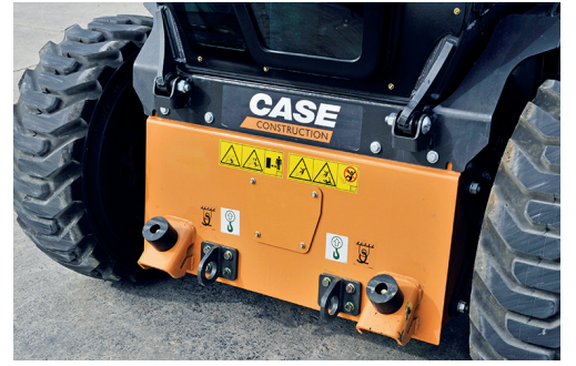
Şasi üzerindeki kauçuk takozlar itme gücünü destekler!
