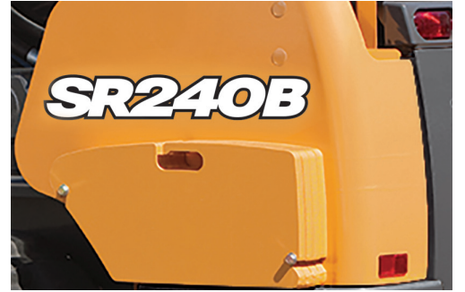
İlave arka ağırlıklar ile daha fazla taşıma kapasitesi
