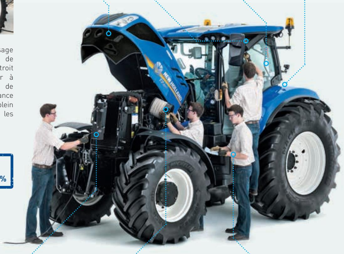
Le système de refroidissement s'ouvre vers l'avant pour un nettoyage plus rapide et plus facile.
