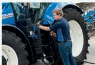
O bocal de enchimento do depósito AdBlue de 48 litros é mais estreito do que o do depósito de combustível standard, evitando o enchimento acidental com combustível. Só precisa de o encher uma vez a cada dois reabastecimentos do depósito de combustível.
