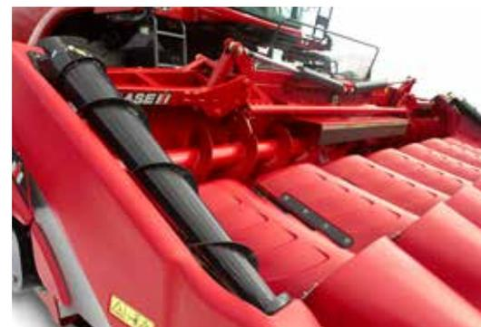
Diviseur rotatif pour les récoltes couchées et diffuseurs à rétention des grains : une conception parfaite pour des pertes nulles
