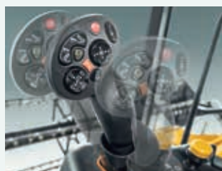
Le mouvement par impulsions permet à l'utilisateur de faire varier sa vitesse et de changer de direction.
